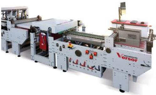
Die Kombination des Versor Inspector Vorstellmoduls und des EyeC ProofRunner Carton Folder Gluer ermöglicht die modernste Druckbildinspektion auf einer vorhandenen Faltschachtelklebemaschine.
